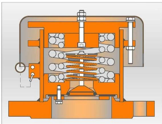
Рис. 17: Клапан КИТО® для вагона-цистерны
