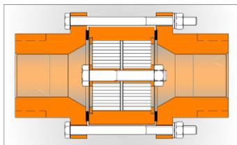
Для предотвращения распространения реакции в подсоединенные части установки используются противодефлаграционные предохранители КИТО® (рис. 11-13).
