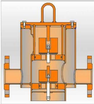
Рис.20: Клапан избыточного/пониженного давления KITO®
