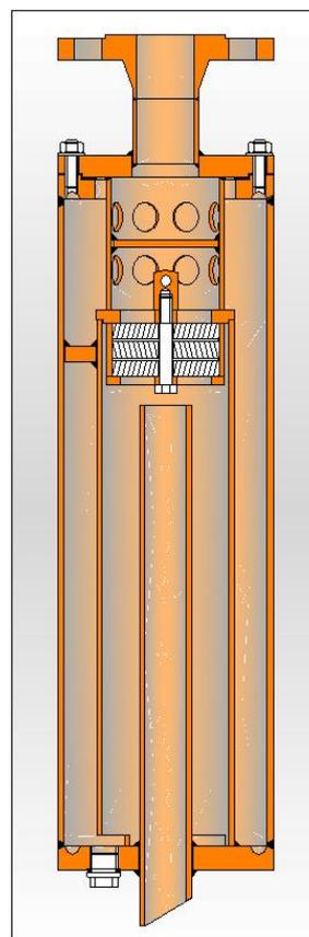
Рис. 8: Противодетонационный преградитель KITO® жидкостного типа
