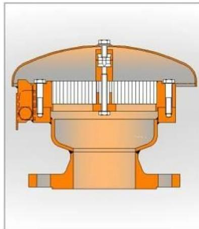
Рис. 2: Колпак КИТО®, стойкий к длительному воздействию огня
